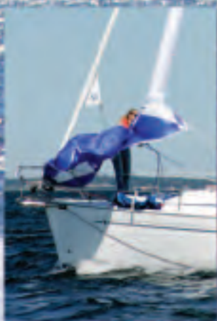
Til venstre ses en gennaker i færd med at blive bjærget med en North Snuffer™.
